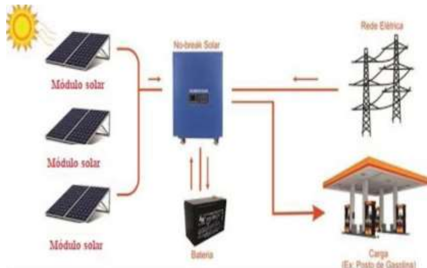
Figura 5 – Esquema de funcionamento de um sistema Bi-modal
