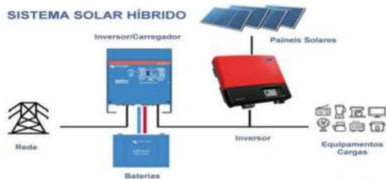
Figura 4 – Esquema de Funcionamento de um Sistema All in one
